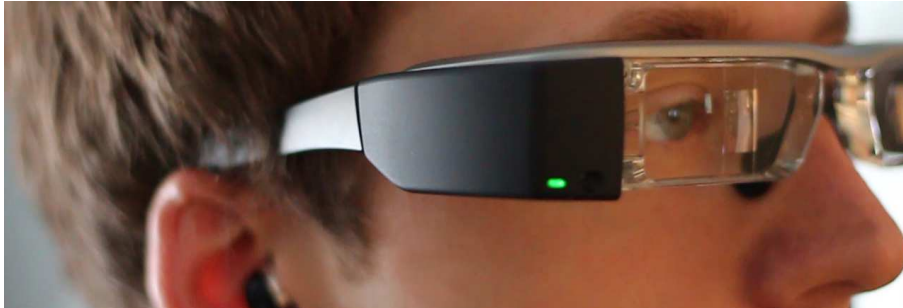
Abbildung 1: Ein Beispiel für eine binokulare (optical see-through) Datenbrille: Epson Moverio BT-200. (Bildquelle: http://www.scopear.com/wp-content/uploads/2014/01/ScopeAssist_G.jpg )
