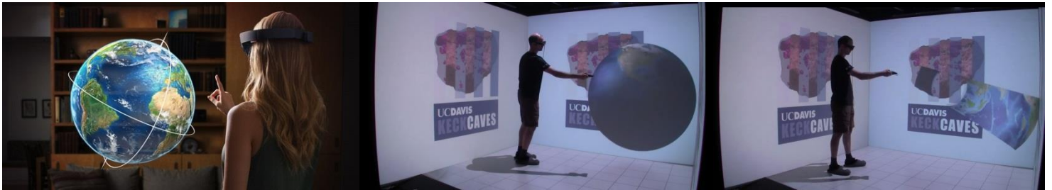
Abbildung 1: Konzept einer immersiven Augmented Reality Anwendung (a), Simulation eines großen FOV (b), und eines beschränkten FOV von 30^\circ \times 17.5^\circ (c).
